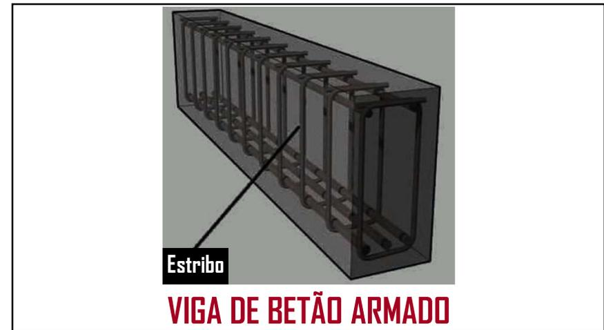
**Como calcular a quantidade de varões de aço para armadura longitudinal de uma viga de betão armado**
